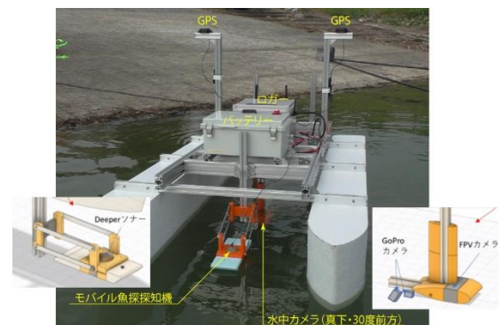
写真-1 ASVの搭載機器の概要
