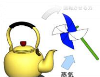
写真3 燃焼で蒸気が発生させ、蒸気での発電機回転の説明
